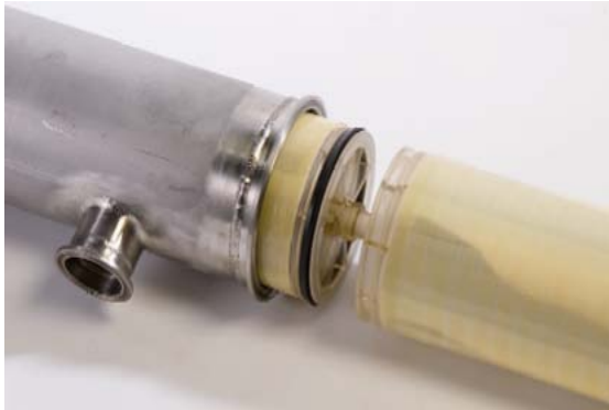
Einführen des Interconnectors in das Permeatrohr des 2. Moduls
